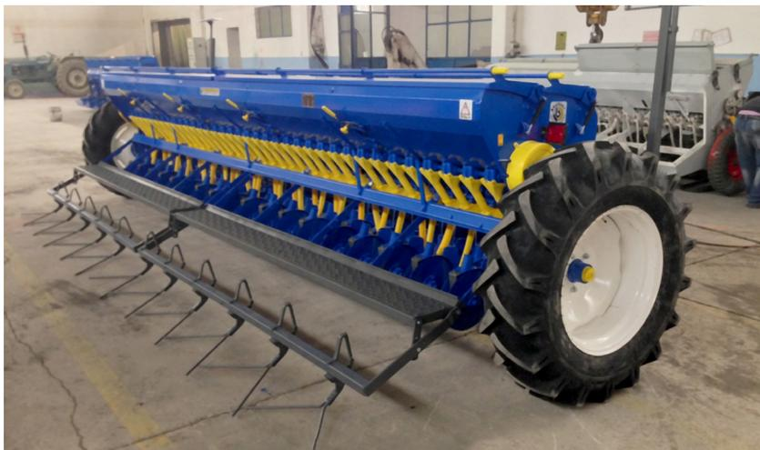
Фото 7. Сеялка зернотравяная СЗТ-3,6
