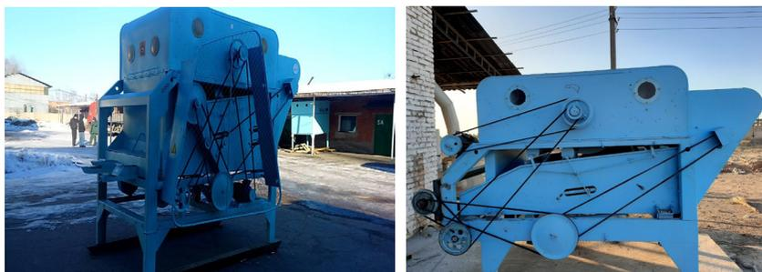
Фото 12. Машины для очистки и сортировки семян
